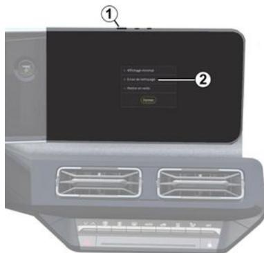
Para utilizar um pano de microfibras no ecrã do sistema multimédia quando este estiver ligado, efetue uma pressão breve no comando **1** no painel multimédia e, em seguida, prima "Ecrã de limpeza" **2** para colocar o ecrã tátil no modo inativo.
