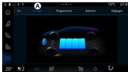
No separador "Energia" **A**, o sistema multimédia permite-lhe ver os fluxos de energia do veículo.
