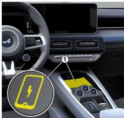
A zona de carregamento por indução **1** pode ser utilizada para carregar um telefone sem necessitar de um cabo.
