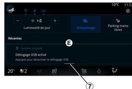
El centro de notificaciones **E**, al que se tiene acceso con el botón **7** o deslizando rápidamente la pantalla multimedia desde la zona **A** hacia el centro, le da acceso a las notificaciones, "Perfil" y a determinadas funciones. Para salir del centro de notificaciones, presionar **7** o deslizar rápidamente el dedo desde la zona **D** hacia el centro de la pantalla.
