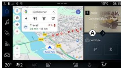
El sistema dispone de una página "Navegación" personalizable. Se compone de una serie de widgets ubicados en el área **A** que facilitan el acceso a la información y a funciones como *My driving*, la radio, los ajustes de la presión de los neumáticos, etc.
