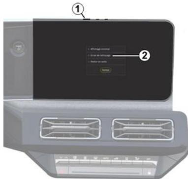
Si desea utilizar un paño de microfibra en la pantalla del sistema multimedia cuando esté encendida, presione brevemente el mando **1** en el panel multimedia y, a continuación, pulse "Limpiar la pantalla" **2** para poner la pantalla táctil en modo inactivo.
