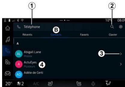
En Mundo "Teléfono"
