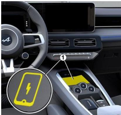
La zona de carga por inducción **1** permite recargar un teléfono sin necesidad de cables.
