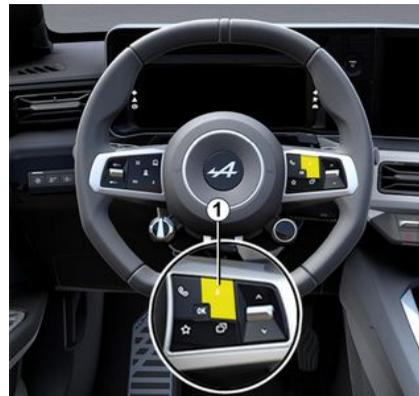
Puede utilizar el comando de voz de la replicación del teléfono inteligente sin necesidad de utilizar la pantalla, manteniendo presionado el botón 1, a continuación, se emite un sonido de confirmación y se visualiza en esta.
