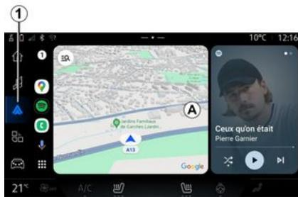
"Android Auto™" es una aplicación que permite la replicación del teléfono inteligente en la pantalla del sistema multimedia.
