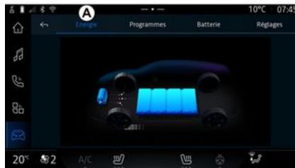
En la pestaña "Energía" **A**, el sistema multimedia permite consultar los flujos de energía del vehículo.
