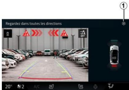
Cuando se introduce la marcha atrás, la cámara de marcha atrás situada en la parte trasera del vehículo se activa para transmitir la vista de la zona inmediatamente detrás del vehículo a la pantalla multimedia.
