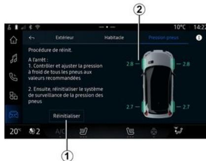
En el sistema multimedia, puede comprobar el estado de la presión de los neumáticos.
