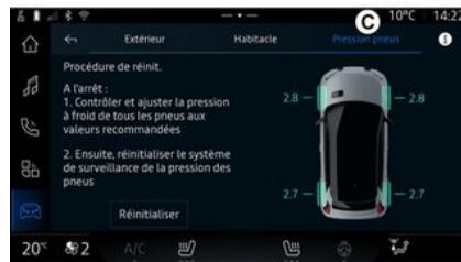
Este menú permite comprobar el estado de la presión de los neumáticos del vehículo y realizar una reinitialización.
