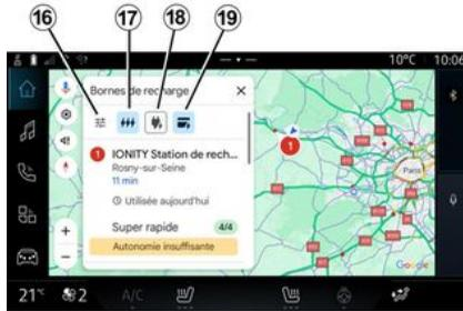
En los ajustes del terminal de carga **15**, puede configurar los filtros en **16** para que la pantalla de navegación únicamente muestre los terminales que cumplan determinados criterios, por ejemplo:
