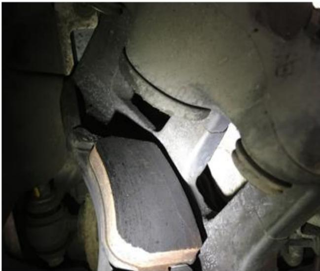
Exemple **OK ET NOK** de plaquettes glacées et de disques mal rodés
