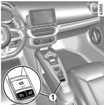
Il regolatore di velocità è una funzione che vi consente di mantenere la velocità di guida entro il limite prescelto, soprannominato **velocità di regolazione**.
