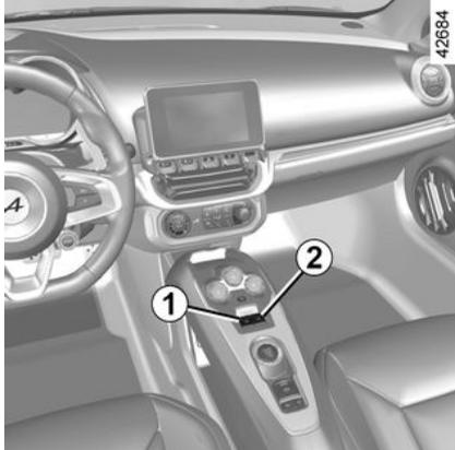
Premere o alzare al massimo e brevemente il contattore **1** o **2**: il vetro si alzerà o abbasserà completamente. Ogni ulteriore azione sul pulsante arresta il funzionamento del vetro.
