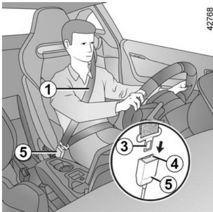
Svolgere la cintura **lentamente e senza strappi** e assicurarsi di bloccare la fibbia **3** nel modulo di bloccaggio **5** (controllare che sia ben agganciata tirando la fibbia **3**).
