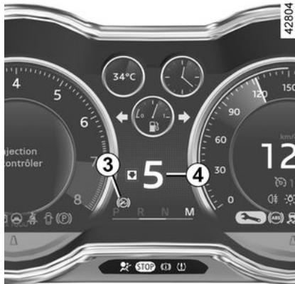
A veicolo fermo, motore acceso o contatto inserito, **premere e tenere premuto il contattore N** fino a quando la spia integrata nel contattore N diventa rossa. Sul quadro della strumentazione viene visualizzato P. Il cambio passa in posizione di parcheggio (P).
