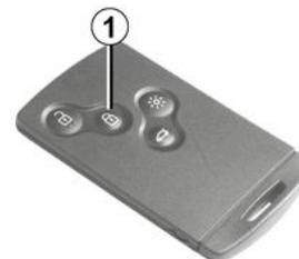
Se il veicolo è dotato della funzione di chiusura ad effetto globale, questa permette di bloccare le parti apribili e d'impedire l'apertura delle porte dalle maniglie interne (in caso di rottura del vetro con tentativo d'apertura delle porte dall'interno).
