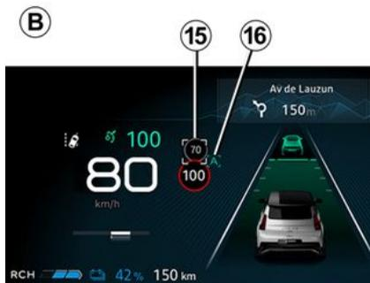
Utilizzando la telecamera, la funzione di rilevamento dei cartelli stradali ➔ 237 e le mappe, il sistema anticipa la regolazione automatica della velocità del veicolo finché il successivo segnale del limite di velocità **15** non viene identificato e superato.
