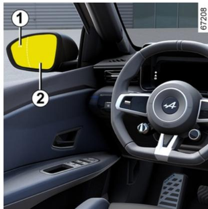
Quando viene aperta una porta e viene rilevato un oggetto in movimento, la spia **1** viene visualizzata sul retrovisore esterno **2** e, a seconda del veicolo, si accendono le plafoniere sulla porta anteriore.
