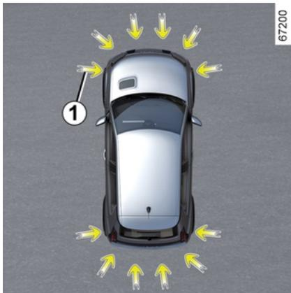
Come indicato dalle frecce **1**, i rilevatori a ultrasuoni installati sui paraurti del veicolo consentono di trovare spazi di parcheggio accessibili e assistere nelle manovre di parcheggio.
