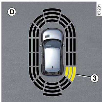
In base all'orientamento delle ruote, il sistema determina la traiettoria del veicolo e segnala l'eventuale rischio di urto contro un ostacolo 3 situato su un lato del veicolo.
