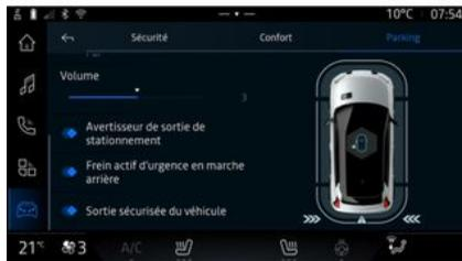
Per attivare o disattivare la funzione tramite lo schermo multimediale 1 **1**, selezionare il mondo "Veicolo", quindi "Assistenza alla guida" e infine "Parcheggio". Attivare "Frenata automatica di emergenza posteriore".
