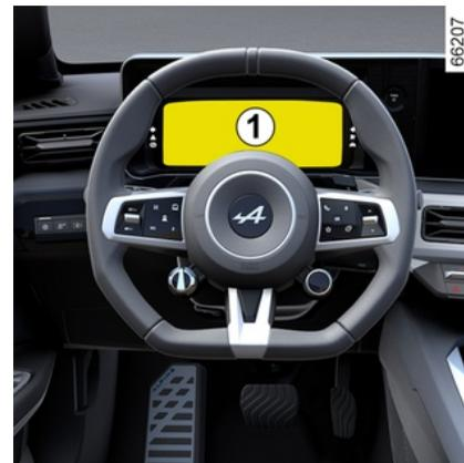
Se il sistema rileva un errore nella pressione degli pneumatici, sul quadro della strumentazione **1** viene visualizzato un messaggio di avviso.
