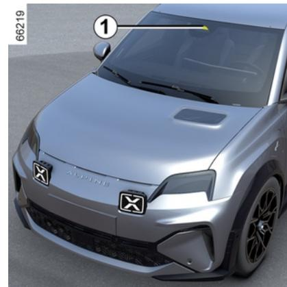
Grazie alle segnalazioni dalla telecamera **1**, la funzione attiva un'azione correttiva sul sistema sterzante del veicolo quando viene superata una linea continua o tratteggiata o in prossimità del bordo della strada (separatori, barriera, marciapiede, argine e così via.) senza l'attivazione delle spie di direzione.
