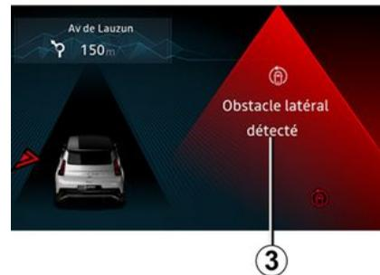
Quando l'oggetto rilevato è molto vicino, viene emesso un segnale acustico insieme al messaggio **3** "Ostacolo later. rilevato" sul quadro della strumentazione.
