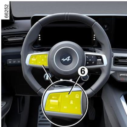
Per adattare il valore nominale del limitatore di velocità o del cruise control adattivo ai limiti di velocità rilevati: premere brevemente l'interruttore **6** per regolare la velocità del veicolo al limite di velocità indicato sull'ultimo segnale del limite di velocità rilevato;
