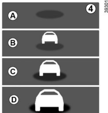
Con la funzione attivata, la spia **4** viene visualizzata sul quadro della strumentazione e informa il conducente della distanza tra il veicolo e quello che lo precede.
