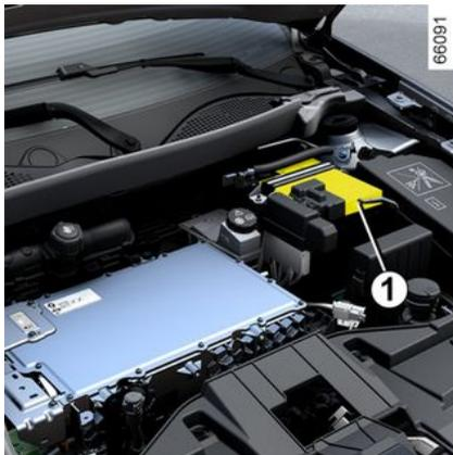
La batteria 12 V fornisce l'energia necessaria per il funzionamento dell'equipaggiamento del veicolo (luci, tergicristalli, finestrini, sistema audio e così via) e di alcuni sistemi di sicurezza, come la frenata assistita.
