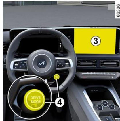
A seconda del veicolo, premere il contattore 4 tutte le volte necessarie per raggiungere la modalità Save.
