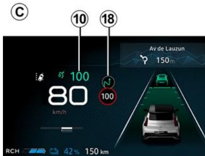
Utilizzando la telecamera, la funzione di rilevamento dei cartelli stradali ➔ **237** e le mappe, il sistema è in grado di anticipare e gestire l'adattamento automatico della velocità di crociera **10** quando il veicolo si avvicina a una rotonda o a una curva.
