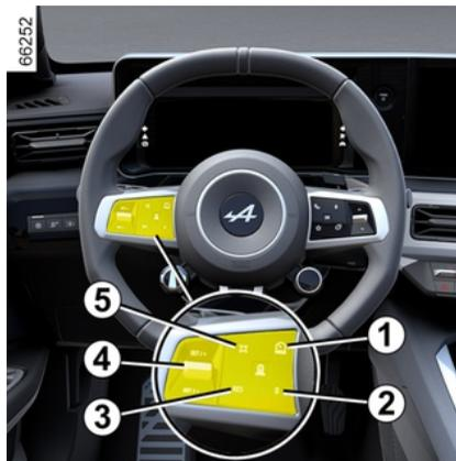
**1.** Contattore per selezionare/deselezionare i sistemi di assistenza alla guida, a seconda del veicolo:
