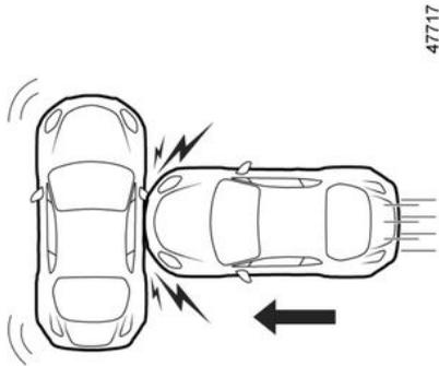
In caso di urto laterale con un altro veicolo di categoria equivalente o superiore, ad una velocità d'impatto uguale o superiore a 50 km/h.
