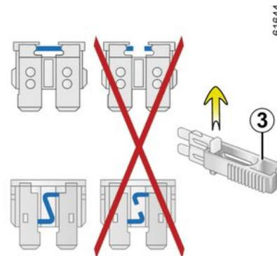
Staccare il fusibile utilizzando le pinzette **3** poste sul pannello del fusibile.
