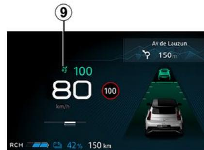
Il radar è in grado di rilevare i veicoli che precedono il vostro veicolo. Il sistema non può funzionare correttamente se l'area di rilevamento radar è oscurata o se il segnale è interrotto.
