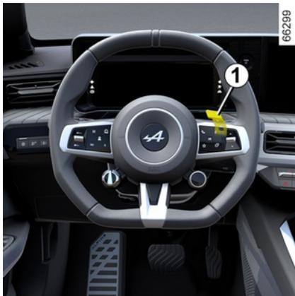
Se si preme il pulsante "OV" **1** sul volante, il motore incrementa temporaneamente la potenza, aumentando all'istante l'accelerazione del veicolo (boost).
