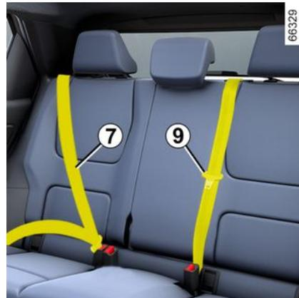
Il bloccaggio, lo sbloccaggio e la regolazione si effettuano nello stesso modo delle cinture anteriori.
