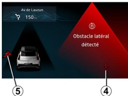
Durante la guida a una velocità compresa tra circa 70 km/h e 110 km/h, se sussiste un rischio di collisione con un veicolo proveniente dalla direzione opposta in una corsia adiacente e all'interno della zona di rilevamento **C**, senza che sia stato attivato l'indicatore di direzione, il sistema:
