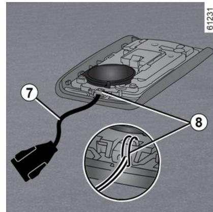
Inserire la cinghia nel componente **8** e fare passare l'estremità della cinghia manuale attraverso la fibbia.
