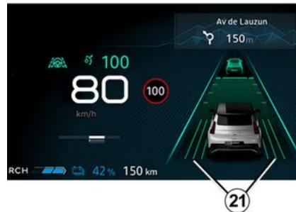
Per regolare la posizione nella corsia, la funzione "Centraggio corsia" deve essere in modalità di regolazione, la spia verde **22** deve essere visualizzata sul quadro della strumentazione e la velocità del veicolo deve essere inferiore a 50 km/h.
