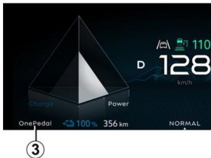
Con la posizione **D** inserita, ruotare il comando **2** in direzione **A** fino a quando non appare il messaggio "One Pedal attivato". Viene visualizzata la spia luminosa UN PEDALE **3**, accompagnata da un segnale acustico, per confermare che la funzione è attivata.
