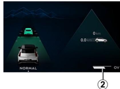
In qualsiasi momento è possibile verificare se la funzione è disponibile consultando l'autonomia residua sull'indicatore **OV 2** visualizzato sul quadro della strumentazione.
