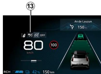
Premere il contattore 3 per selezionare il regolatore di velocità adattivo 13. La spia 9 si accende in grigio. Il messaggio "Adaptive Cruise Control pronto" viene visualizzato sul quadro della strumentazione.
