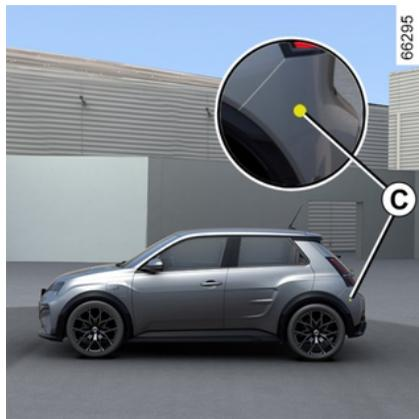
Assicurarsi che la zona **C** intorno ai radar su ciascun lato del paraurti posteriore non sia ostruita (da sporcizia, fango, neve e così via). Se uno dei sensori è oscurato, sul quadro della strumentazione verrà visualizzato il messaggio "Radar laterali senza visibilità". Pulire la zona in cui si trovano i sensori.
