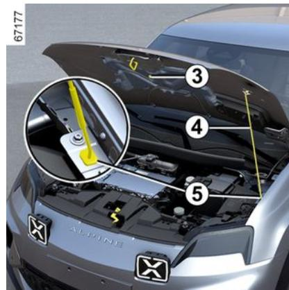
Dopo aver sollevato il cofano e disinnestato il martinetto **4** dal suo alloggiamento **3**, per sicurezza è **necessario** posizionare il martinetto nel relativo alloggiamento **5**.
