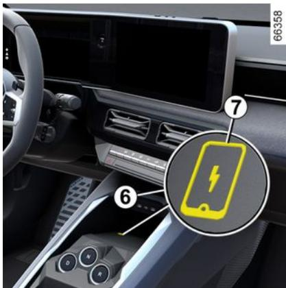
A seconda del veicolo, il simbolo 7 indica che è possibile posizionare il telefono nell'area 6 per caricarlo senza cavo.
