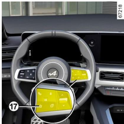
A seconda del veicolo, premendo il comando al volante **17**, è possibile attivare le seguenti funzioni in base alle impostazioni utente memorizzate definite in precedenza:
