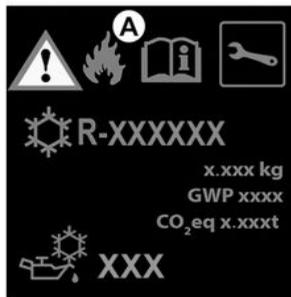
Il circuito del fluido refrigerante (di cui alcuni componenti sono ermeticamente chiusi) può contenere gas fluorurati a effetto serra.
