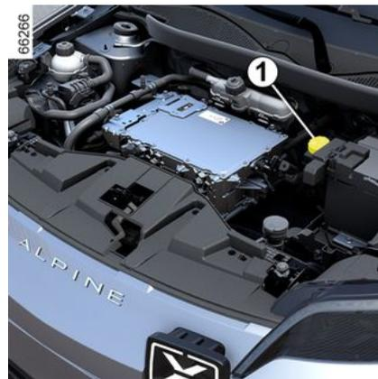
Il controllo del livello si esegue a motore fermo e su superficie orizzontale. Deve essere controllato spesso e comunque ogni volta che si avverte una variazione anche
