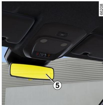
Il retrovisore si scurisce automaticamente quando siete seguiti da un veicolo con i fari accesi o in caso di forte luminosità.
