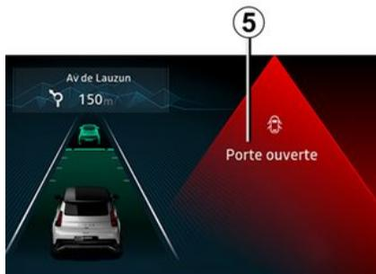
A veicolo fermo e contatto inserito, la spia
