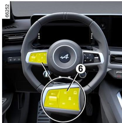
Per adattare l'impostazione di controllo del limitatore di velocità, del regolatore di velocità o del regolatore di velocità adattivo al limite di velocità rilevato, premere il contattore 6.
