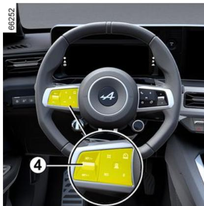
È possibile modificare il limite di velocità premendo ripetutamente o tenendo premuto il comando **4**:
