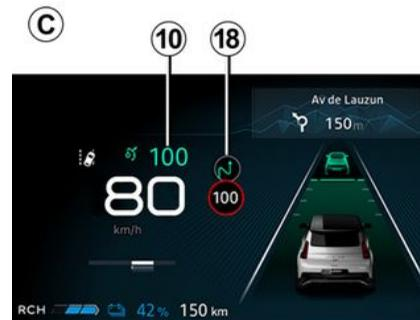
Utilizzando la telecamera, la funzione "Rilevamento segnaletica stradale" ➔ **237** e le mappe, il sistema può anticipare e gestire l'adattamento automatico della
