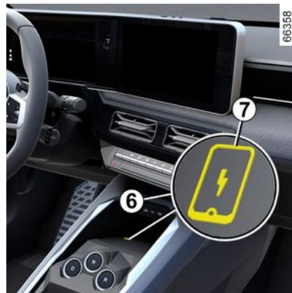
A seconda del veicolo, è presente il simbolo 7 a indicare che è possibile posizionare il telefono nella zona 6 per caricarlo senza cavo.
