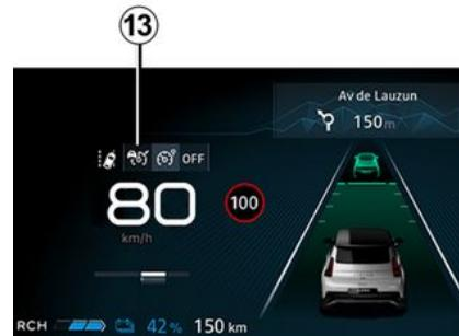
Premere il contattore **3** per selezionare il regolatore di velocità adattivo **13**. La spia **9** si accende in grigio. Il messaggio "Regolatore adattivo pronto SET per attivare" viene visualizzato sul quadro della strumentazione accompagnato da dei trattini per indicare che la funzione regolatore di velocità funziona e in attesa di memorizzare la velocità di regolazione.
