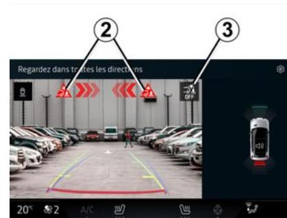
Se il veicolo è dotato di gancio di traino riconosciuto dal sistema ed è stato collegato un rimorchio, la frenata di emergenza attiva in retromarcia viene automaticamente disattivata e sul quadro della strumentazione viene visualizzato il messaggio "Rimorchio: sensori parcheggio indisponibili" insieme alla spia **3** sullo schermo multimediale.
