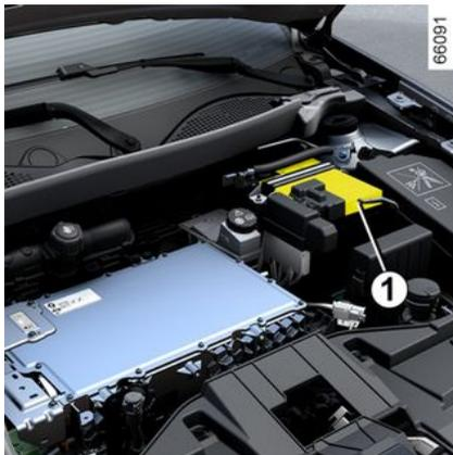
La batteria secondaria è una batteria da 12 V: fornisce energia necessaria per il funzionamento dell'equipaggiamento del veicolo (luci, tergicristalli, finestrini, sistema audio ecc.) e di alcuni sistemi di sicurezza come la frenata assistita.
