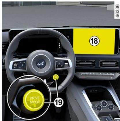
Dal menu MODALITÀ DI GUIDA, accessibile dallo schermo multimediale **18** o premendo il contatto **19**, è possibile attivare la modalità Risparmio, che influisce sul livello di riscaldamento e riduce il consumo di carburante del veicolo. La spia Risparmio viene visualizzata sotto il display della temperatura sullo schermo multimediale **18** per informare l'utente che la modalità Risparmio è attivata.
