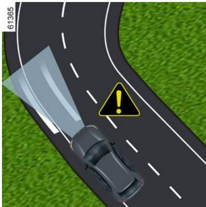
In caso di curva pericolosa e a seconda della velocità del veicolo, le capacità di tenuta della corsia della funzione verranno limitate e il conducente dovrà agire immediatamente sul volante in modo che il veicolo resti nella corsia.
