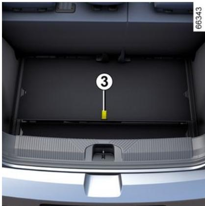
A seconda del veicolo, questo vassoio è destinato a contenere i cavi di ricarica. Il carico massimo consentito per vassoio è di 10 kg.
