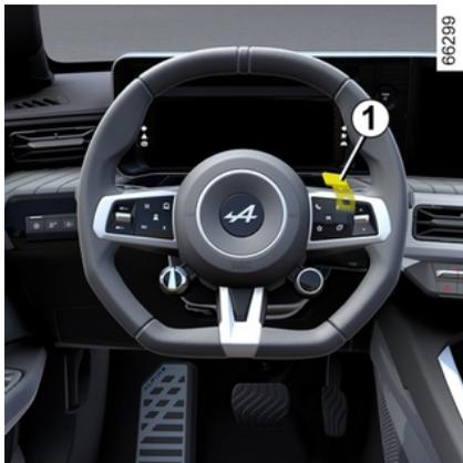
Se si preme il pulsante "OV" **1** sul volante, il motore offre prestazioni massime, aumentando all'istante l'accelerazione del veicolo.
