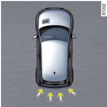
Oltre alla funzione "Assistenza al parcheggio" ➔ 282 e utilizzando le informazioni dei quattro sensori centrali situati nella parte posteriore del veicolo, il sistema rileva gli ostacoli fissi che si trovano dietro al veicolo. Se c'è un rischio significativo di collisione, il sistema fa automaticamente frenare il veicolo.
