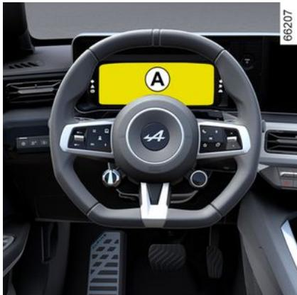
**Quadro della strumentazione A:** si accende quando si apre la porta del conducente. Per regolare la luminosità del cruscotto, consultare il libretto di istruzioni del sistema multimediale.
