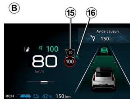
Tramite la telecamera, la funzione "Rilevamento segnaletica stradale" ➔ **237** e le mappe, anticipa la regolazione automatica della velocità del veicolo finché il successivo segnale di limite di velocità **15** non viene identificato e superato.
