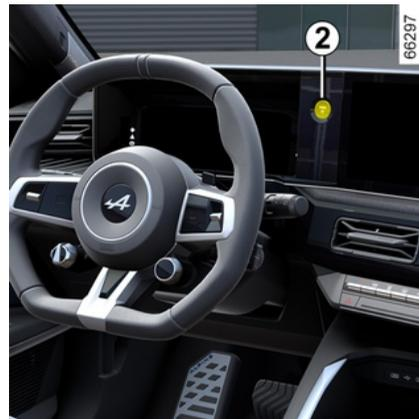
Se lo smartphone non si trova più nell'abitacolo quando si tenta di spegnere il motore, sul quadro della strumentazione viene visualizzato un messaggio: tenere premuto il pulsante di avviamento/spengimento del motore 2 per più di due secondi.
