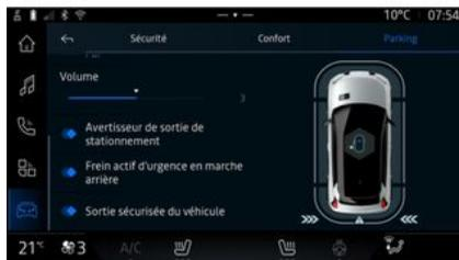
Per attivare o disattivare la funzione tramite lo schermo multimediale 1 **1**, selezionare il mondo "Veicolo", quindi "Assistenza alla guida" e infine "Parcheggio". Attivare la "Frenata attiva di emergenza in retromarcia".
