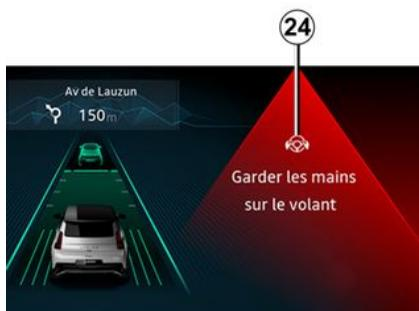
Quando la funzione "Centraggio corsia" non rileva più le mani sul volante, verranno attivati vari livelli di avviso:
