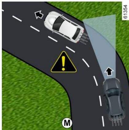
Quando ci si immette in una curva o in un angolo, la telecamera e/o il radar potrebbero non essere temporaneamente in grado di rilevare il veicolo che precede (esempio **M**).
