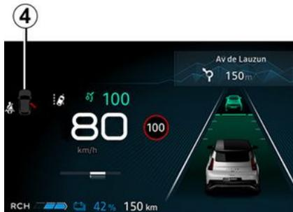
A veicolo fermo e contatto inserito, la spia
