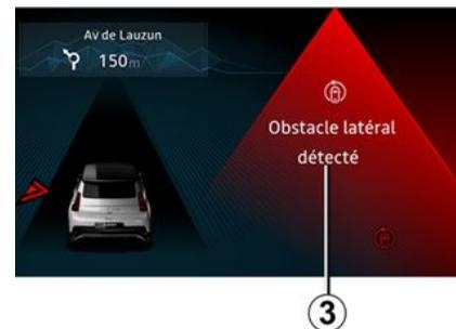
Quando l'oggetto rilevato è molto vicino, viene emesso un segnale acustico insieme al messaggio **3** "Ostacolo later. rilevato" sul quadro della strumentazione.
