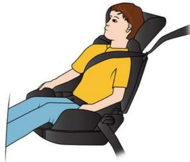
A partire da 15 kg o 4 anni il bambino può viaggiare su un rialzo che permette di adattare la cintura di sicurezza alla sua morfologia. La seduta del rialzo deve essere dotata di guide che posizionano la cintura sulle cosce del bambino e non sul ventre. Lo schienale regolabile in altezza e dotato di una guida della cintura è raccomandato per posizionare la cintura al centro della spalla. Essa non deve mai trovarsi sul collo o sul braccio.
