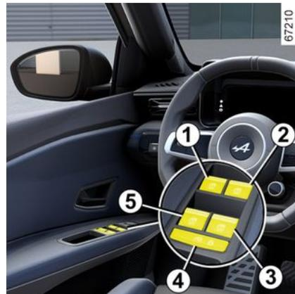
Premere brevemente o alzare a fondo corsa l'interruttore del vetro: il vetro si alzerà o abbasserà completamente. Ogni ulteriore azione sul pulsante arresta il funzionamento del vetro.
