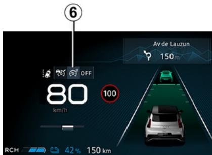
La funzione di limitatore della velocità viene interrotta quando si preme il contattore **1** per deselezionarlo. In tal caso la velocità non è più memorizzata.
