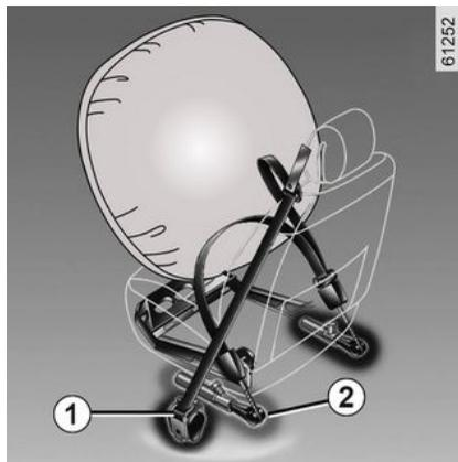
Les prétensionneurs servent à plaquer la ceinture contre le corps, à plaquer l'occupant sur son siège et à augmenter ainsi son efficacité.
