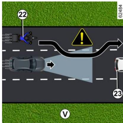
Lorsque votre véhicule est dépassé par un autre véhicule roulant à grande vitesse **22** (moto, voiture...) et que celui-ci s'intercale temporairement entre vous et le véhicule suivi **23**, **le système peut déclencher une accélération, un ralentissement ou un freinage inapproprié.**
