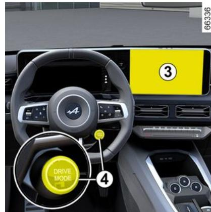
Suivant véhicule, appuyez autant de fois que nécessaire sur le contacteur 4 pour atteindre le mode Save.
