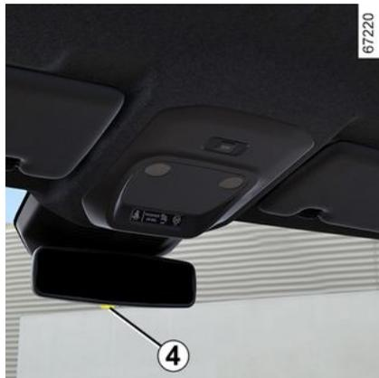
En conduite de nuit, pour ne pas être ébloui par les projecteurs d'un véhicule suiveur, basculez le petit levier 4 situé derrière le rétroviseur.
