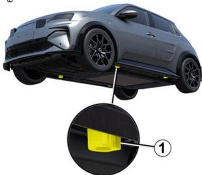
Votre véhicule dispose de quatre points de levage **1** dédiés situés sous le véhicule.
