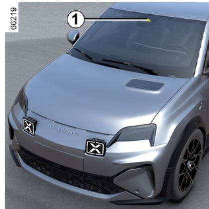
À partir des informations provenant de la caméra **1**, la fonction se déclenche par une action corrective sur le système de direction du véhicule en cas de franchissement d'une ligne ou à l'approche d'un bord de route (terre-plein, barrière, trottoir, talus...) sans avoir activé les feux indicateurs de direction.
