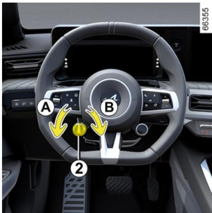
La commande impulsionnelle **2** permet de changer le niveau de freinage régénératif :
