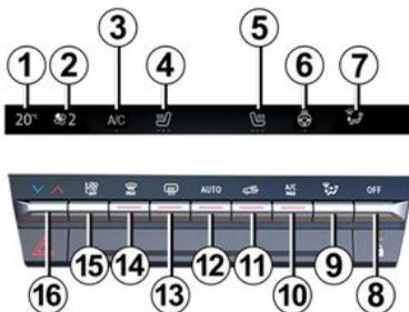
**1.** Indicateur température chauffage conducteur.
