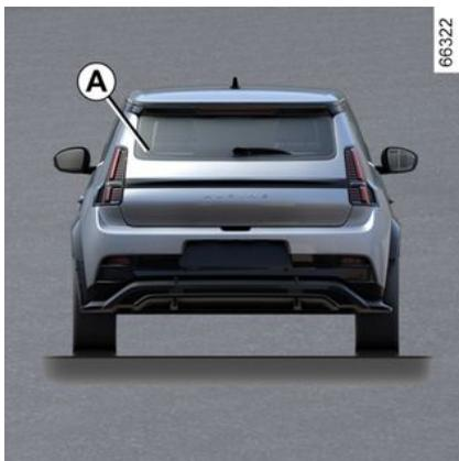
**7** Le QR Code figurant sur l'étiquette **A** permet aux professionnels de secours au moyen d'une tablette ou d'un smartphone, d'accéder immédiatement aux informations techniques utiles pour une intervention sur le véhicule en cas d'accident.
