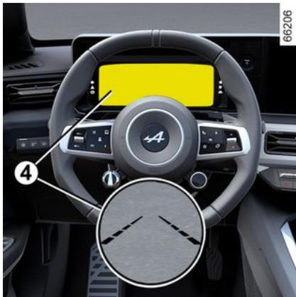
Fonction activée, le témoin
