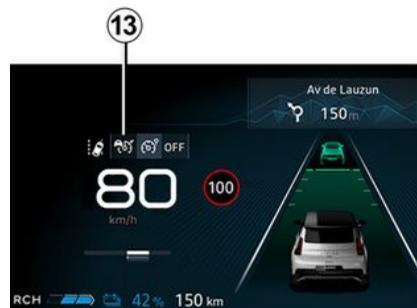
Appuyez autant de fois que nécessaire sur le contacteur 3 pour sélectionner en 13 le régulateur de vitesse adaptatif. Le témoin 9 s'allume en gris. Le message « Régulateur adaptatif prêt à repar-
