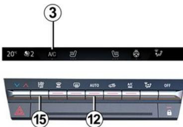
Le système agit sur la vitesse de ventilation, la répartition d'air, le recyclage d'air, la mise en route ou l'arrêt du conditionnement d'air et la température de l'air.
