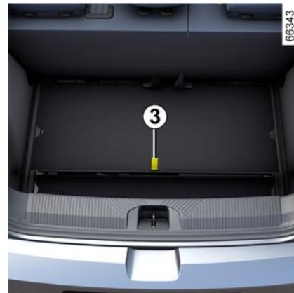
Suivant véhicule, ce bac est destiné aux cordons de charge. La charge maximale admissible par le bac est de 10 kg.
