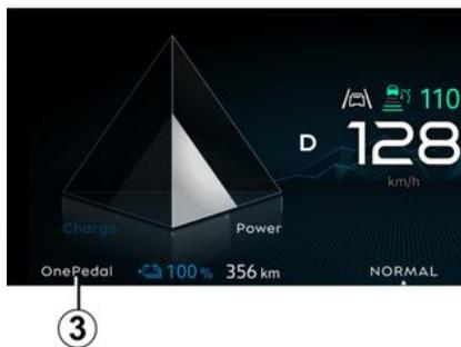
Position **D** engagée, tournez la commande **2** dans le sens **A** autant de fois que nécessaire jusqu'à l'apparition du message « One Pedal activé ». Le témoin **3** ONE PEDAL accompagné d'un signal sonore confirme son activation.
