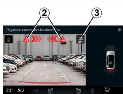
Si le véhicule est équipé d'un attelage reconnu par le système et qu'une remorque a été connectée, le freinage actif d'urgence en marche arrière est automatiquement désactivé et le message suivant s'affiche au tableau de bord : « Remorque: capteurs parking indisponibles », accompagné du témoin 3
