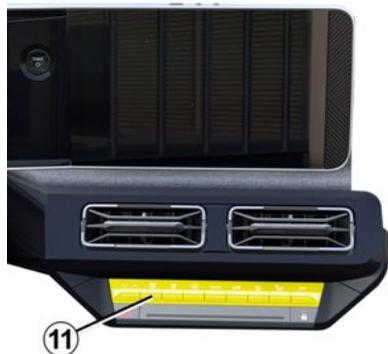
Pour contrôler le débit des aérateurs **1**, **4** et **6** appuyez ou levez la commande **11** en fonction de l'ouverture souhaitée.
