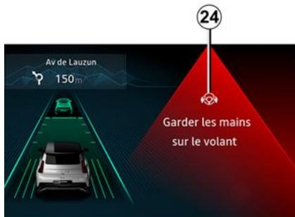
Lorsque la fonction « Centrage voie » ne détecte plus la présence de vos mains sur le volant, plusieurs niveaux d'alerte vont être effectués :
