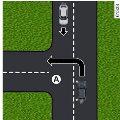
Lorsque vous changez de direction (exemple **A**), les véhicules circulant en sens inverse, sont détectés par le système lorsque :
