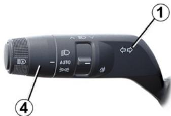
Automatiquement, les feux s'éteignent à l'ouverture de la porte conducteur ou au verrouillage du véhicule ou une minute après l'arrêt du moteur.
