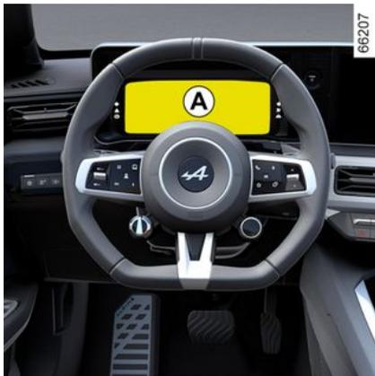
**Tableau de bord A** : il s'éclaire à l'ouverture de la porte conducteur. Pour régler l'intensité lumineuse du tableau de bord, reportez-vous à la notice multimédia.
