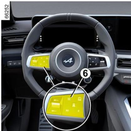
Pour adapter la consigne du limiteur de vitesse ou du régulateur de vitesse adaptatif aux limitations de vitesse détectées : faites un appui court sur le contacteur **6** pour adapter la vitesse du véhicule à la limitation indiquée sur le dernier panneau de signalisation détecté ;
