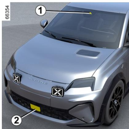
À partir des informations provenant du radar **2** et de la caméra **1**, cette fonction avertit le conducteur de l'intervalle de temps qui le sépare du véhicule qui le précède afin de respecter les distances de sécurité entre les deux véhicules.
