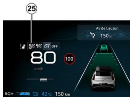
Pour activer la fonction, appuyer sur le contacteur 9 autant de fois que nécessaire pour la mettre en service en 25.
