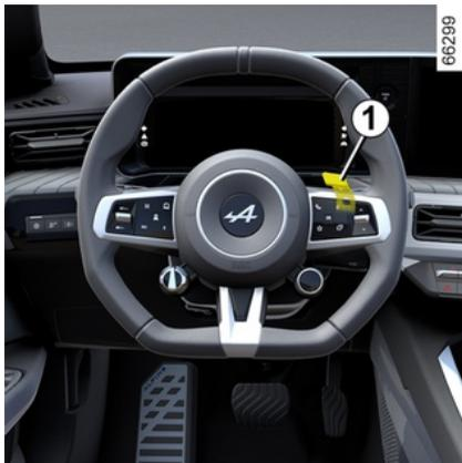
En appuyant sur le bouton « OV » **1** situé sur le volant, un surcroît temporaire de performance est délivré par le moteur permettant ainsi d'obtenir une augmentation instantanée d'accélération du véhicule (Boost).
