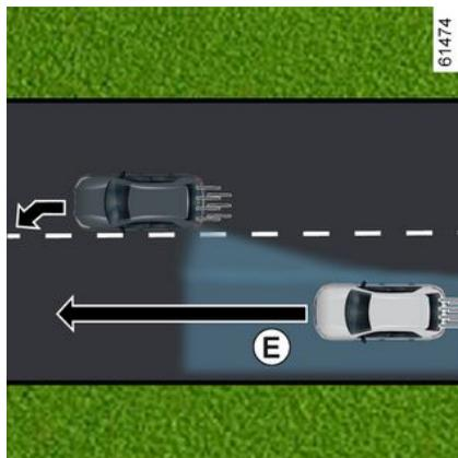
ou discontinue), lorsqu'il y a un risque de collision avec un véhicule qui se trouve dans la zone d'angle mort **D** et se déplace dans la même direction que votre véhicule ou avec un véhicule qui s'approche rapidement par l'arrière sur une voie adjacente dans le périmètre de détection **E**, le système :
