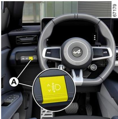
Le contacteur **A** permet de corriger la hauteur des faisceaux en fonction de la charge.
