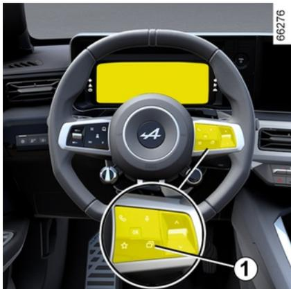
Suivant véhicule, naviguez à l'aide de la commande **1** pour sélectionner les différentes vues sur le tableau de bord.
