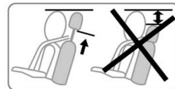
**La position de l'appui-tête complètement abaissée est une position de rangement** : elle ne doit pas être utilisée lorsqu'un passager est assis.
