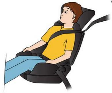
Dès 15 kg ou 4 ans l'enfant peut voyager sur un rehausseur qui permet d'adapter la ceinture de sécurité à sa morphologie. L'assise du rehausseur doit être munie de guides positionnant la ceinture sur les cuisses de l'enfant et non sur le ventre. Un dossier réglable en hauteur et équipé d'un guide sangle est conseillé pour placer la ceinture au milieu de l'épaule. Elle ne doit jamais être sur le cou ou sur le bras.
