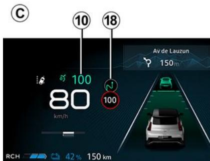
À l'aide de la caméra, de la fonction « Détection de panneaux de signalisation routière » ➔ **231**, et de la cartographie, le système peut anticiper et gérer l'adaptation automatique de la vitesse de régulation **10**, lorsque le véhicule aborde un rond-point ou un virage.
