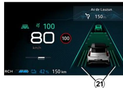
Pour activer l'ajustement de la position dans la voie, la fonction « Centrage voie » doit être en régulation avec le témoin **22** affiché en vert au tableau de bord et la vitesse du véhicule inférieure à 50 km/h.
