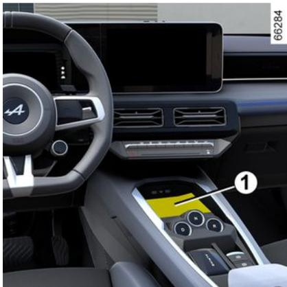
À la première utilisation et/ou à chaque utilisation d'un nouveau smartphone, il est nécessaire de lancer un calibrage de votre clé digitale avec votre véhicule.
