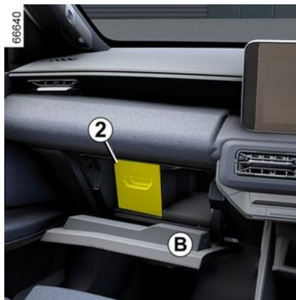
Les fusibles sont accessibles derrière la boîte à gants dans l'habitacle **B**. Ouvrez la porte de la boîte à gants à l'aide du bouton d'ouverture.
