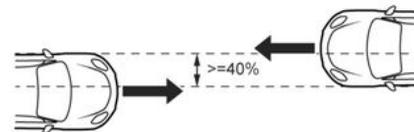
**Les cas suivants provoquent le déclenchement des prétensionneurs ou des airbags.**
