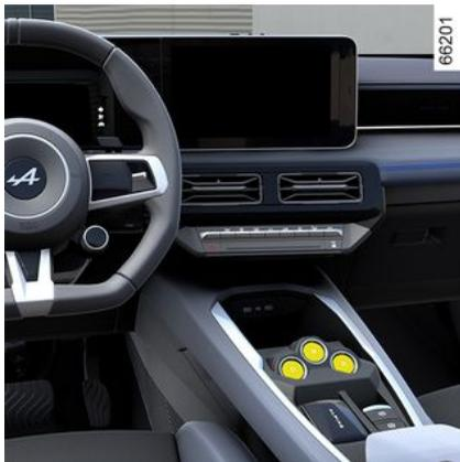
Les contacteurs **R**, **N** et **D** vous permettent de sélectionner les différentes positions de la boîte de vitesses :
