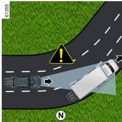
Le système peut détecter des véhicules circulant sur une voie adjacente lorsque :
