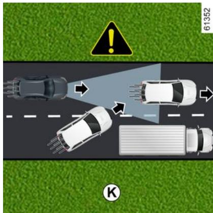
Le système détecte uniquement les véhicules (voiture, camion, moto) circulant dans le même sens que votre véhicule.
