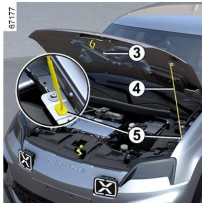
Levez le capot, dégrafez la béquille **4** de sa fixation **3** et, pour votre sécurité, placez-la **impérativement** dans l'emplacement **5**.
