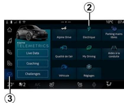
Véhicule à l'arrêt, moteur allumé, depuis le Monde « Véhicule » **3** de l'écran multimédia **1**, appuyez sur le menu « Électrique » **2** pour paramétrer la programmation de charge et/ou de confort de votre véhicule.
