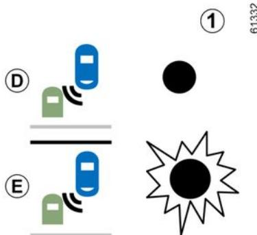
Premier avertissement : **indicateur de direction non activé**, l'indicateur 1 signale qu'un véhicule est détecté dans la zone d'angle mort et/ou qu'un véhicule s'approche rapidement par l'arrière sur une voie adjacente.
