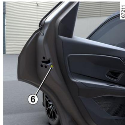
Pour rendre impossible l'ouverture des portes arrière de l'intérieur, baissez le levier 6 et vérifiez de l'intérieur que les portes sont bien condamnées.
