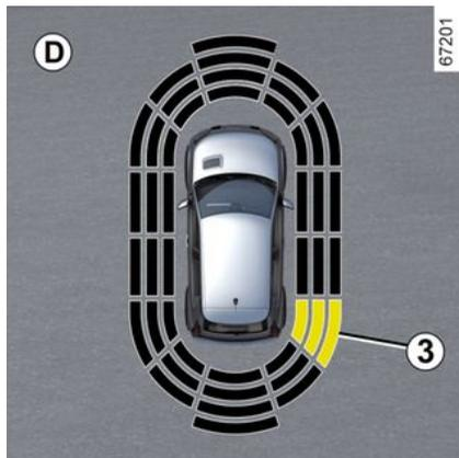
Suivant l'orientation des roues, le système détermine la trajectoire du véhicule et vous avertit du risque ou non de collision avec un obstacle 3 situé sur le côté du véhicule.
