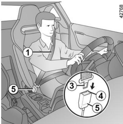
Desenrollar la correa **lentamente y sin tirones** y asegurar que la hebillas **3** se bloquea en el cierre **5** (controlar que está bloqueada tirando de la hebillas **3**).
