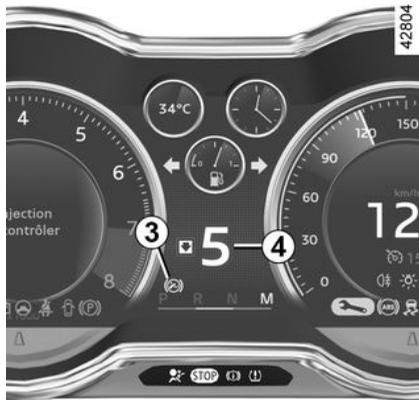
Con el vehículo parado, el motor en marcha o el contacto puesto, **mantenga pulsado el interruptor N** hasta que el testigo integrado en el interruptor N aparezca en rojo. P aparece en el cuadro de instrumentos. La caja de cambios pasa a la posición de aparcamiento (P).
