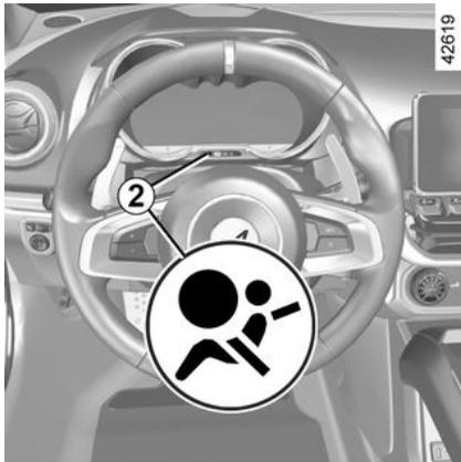
El testigo 2
