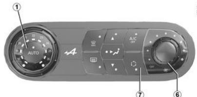
Esta función se gestiona automáticamente, pero puede activarla manualmente. En este caso, la operación se confirma mediante la iluminación de una luz indicadora en el botón **7**.
