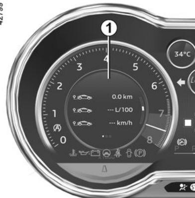
Si el vehículo está equipado, esta función integrada en el ordenador de a bordo **1** le permite la activación/desactivación y el ajuste de algunas funciones del vehículo.
