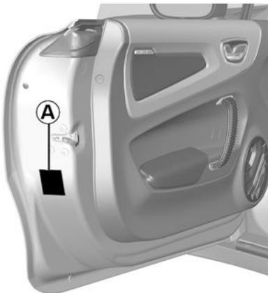
Para leerla, abra la puerta del conductor. La etiqueta **A** se encuentra en el borde de la puerta o, según el vehículo, en la parte inferior de esta.
