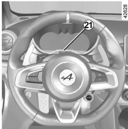
**i** No se debe colocar ningún objeto sobre el soporte del panel de instrumentos **21**.
