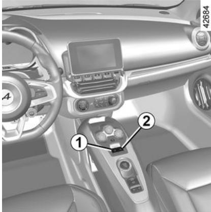
Pulse brevemente el interruptor **1** o **2** hasta el máximo posible: el cristal se abrirá o cerrará. Una acción sobre el mando detiene el desplazamiento del cristal.
