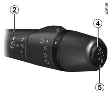
Presione el botón **5** en la palanca **2** hasta que se muestre el reloj.
