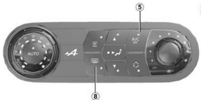
Presionar el botón **8** y se enciende el testigo incorporado. Esta función permite el deshielo de los retrovisores exteriores y (según el vehículo) la luneta trasera.
