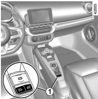
La función limitador de velocidad queda interrumpida cuando actúa en el interruptor **1**, en este caso la velocidad limitada no queda memorizada. El apagado del testigo
